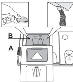
**Чтобы открыть дозатор моющего средства, освободите фиксатор A. Загрузите моющее средство только в сухой дозатор B. Моющее средство для предварительной мойки поместите непосредственно в моечную камеру.**
