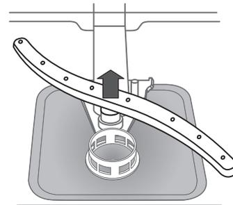
Нижнюю лопасть можно снять, потянув ее вверх.
