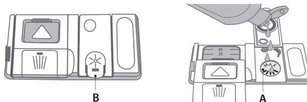
1. Откройте дозатор **B** нажав и потянув вверх язычок крышки.
